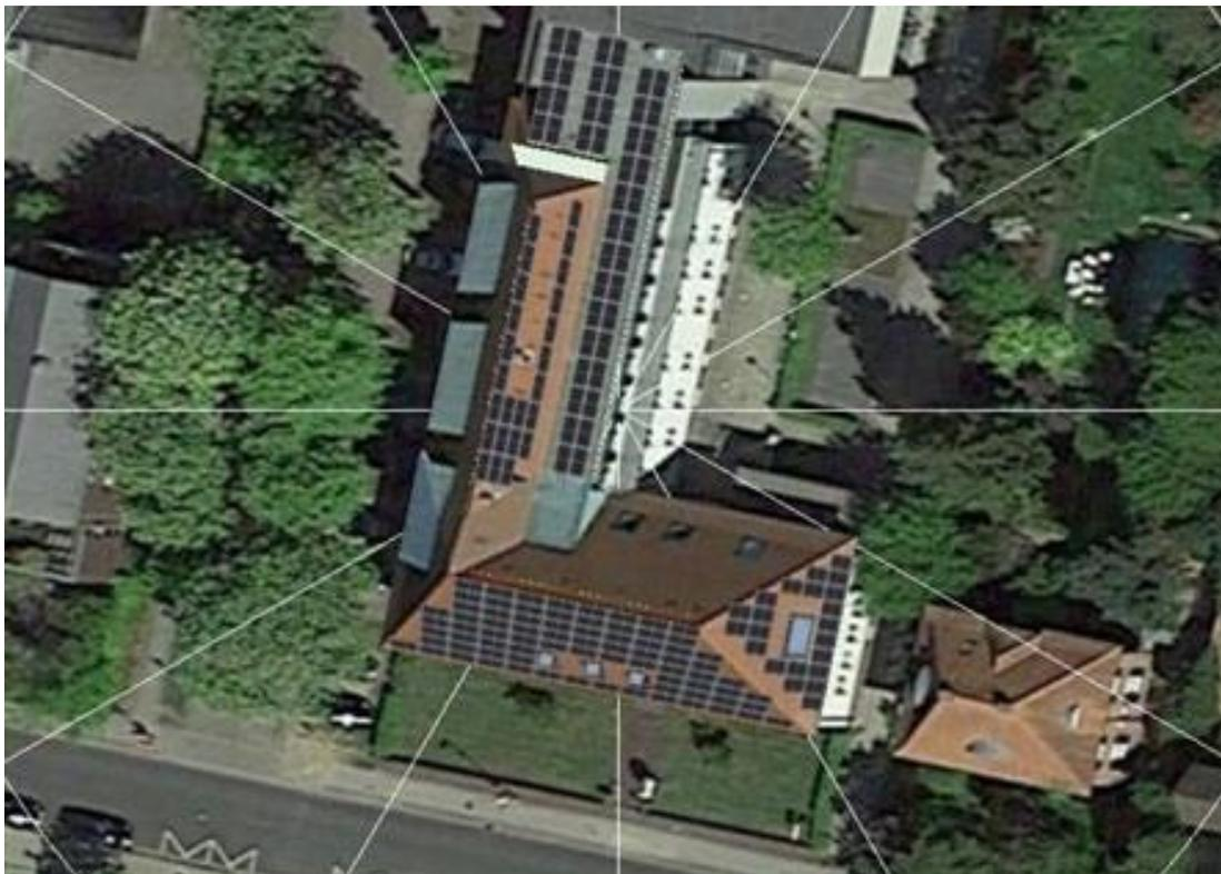
Abbildung 32 Vorschlag Dachbelegung mit einer PV-Anlage
