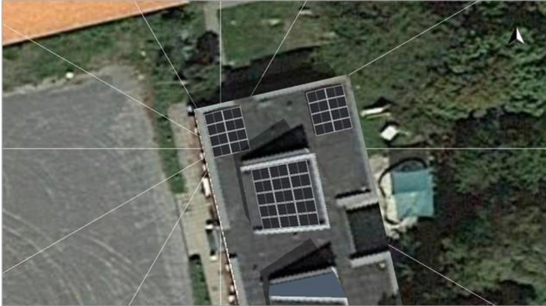
Abbildung 25 Vorschlag Dachbelegung mit einer PV-Anlage
