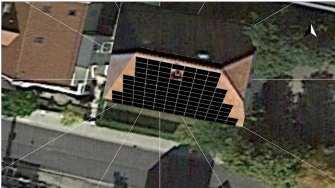
Abbildung 38 Vorschlag Dachbelegung mit einer PV-Anlage
