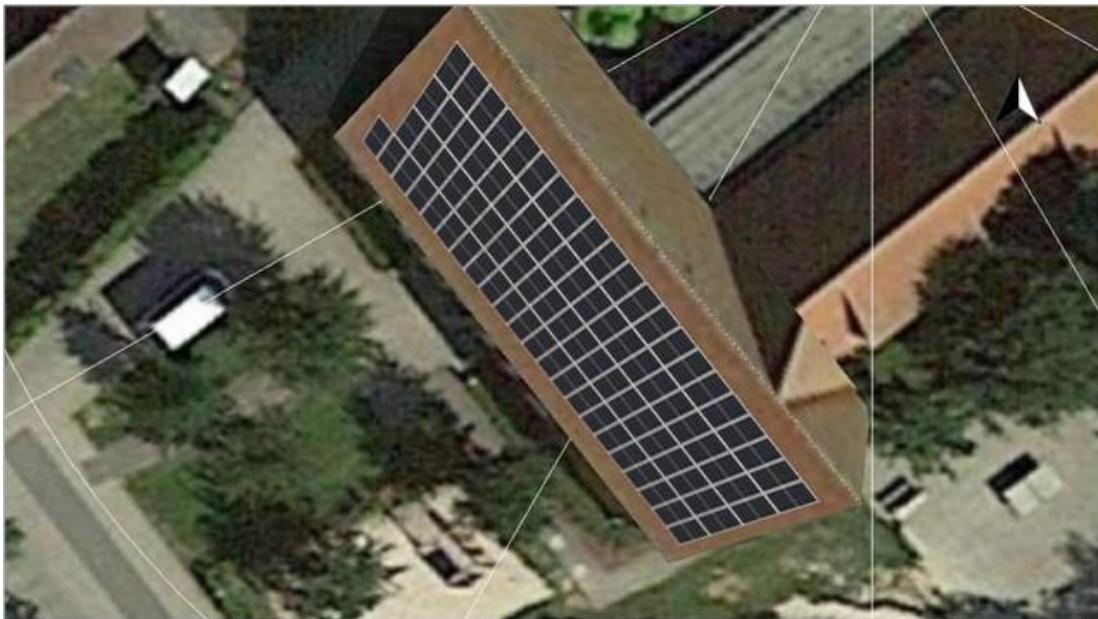
Abbildung 34 Vorschlag Dachbelegung mit einer PV-Anlage
