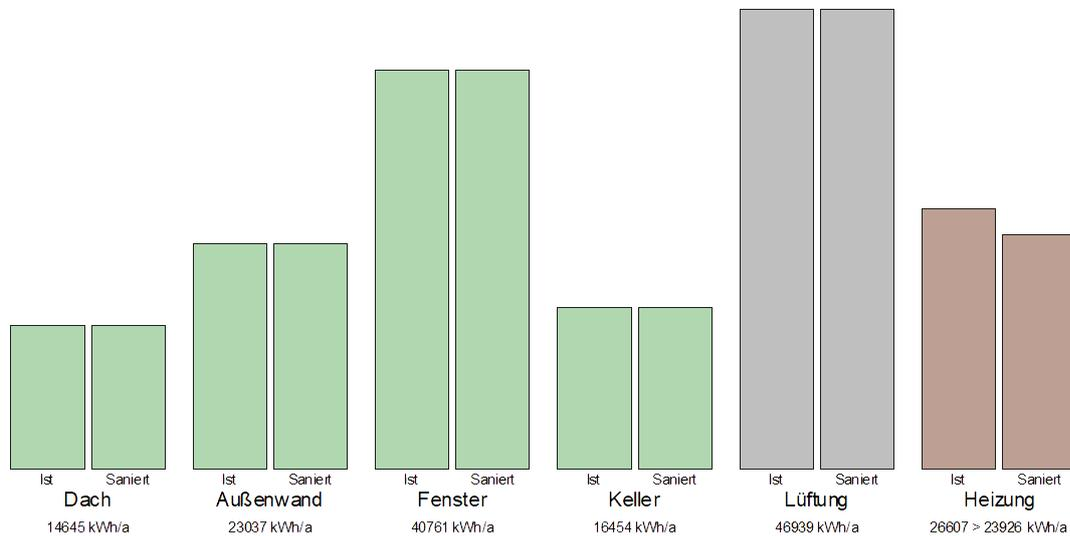
Der derzeitige Endenergiebedarf von 122.380 kWh/Jahr reduziert sich auf 119.717 kWh/Jahr. Es ergibt sich somit eine Einsparung von 2.664 kWh/Jahr, bei gleichem Nutzerverhalten und gleichen Klimabedingungen.
