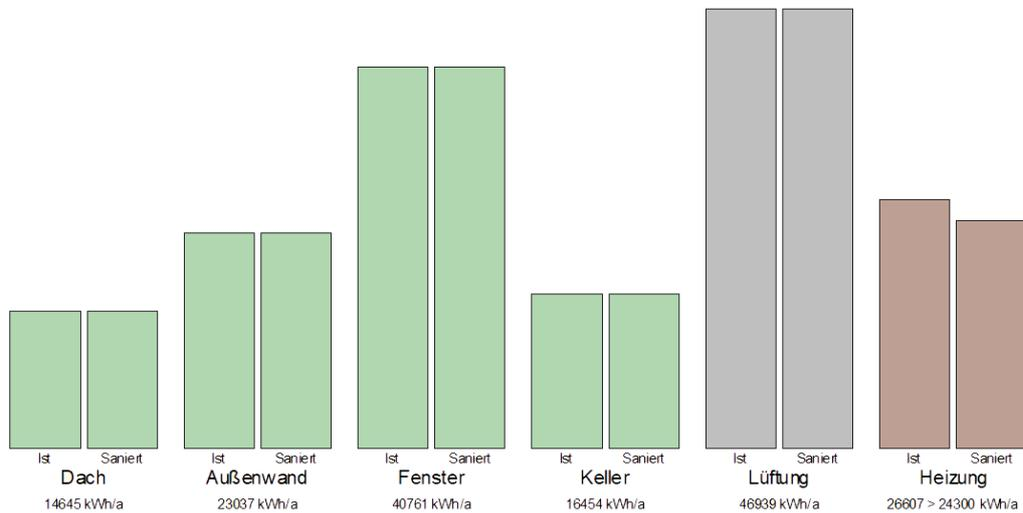
Der derzeitige Endenergiebedarf von 122.380 kWh/Jahr reduziert sich auf 121.974 kWh/Jahr. Es ergibt sich somit eine Einsparung von 406 kWh/Jahr, bei gleichem Nutzerverhalten und gleichen Klimabedingungen.
