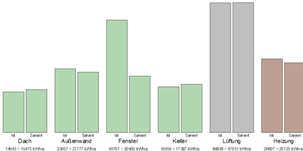
Der derzeitige Endenergiebedarf von 122.380 kWh/Jahr reduziert sich auf 108.492 kWh/Jahr. Es ergibt sich somit eine Einsparung von 13.888 kWh/Jahr, bei gleichem Nutzerverhalten und gleichen Klimabedingungen.
