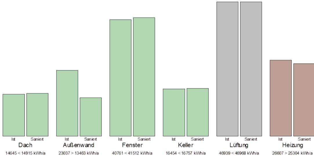
Der derzeitige Endenergiebedarf von 122.380 kWh/Jahr reduziert sich auf 113.839 kWh/Jahr. Es ergibt sich somit eine Einsparung von 8.542 kWh/Jahr, bei gleichem Nutzerverhalten und gleichen Klimabedingungen.
