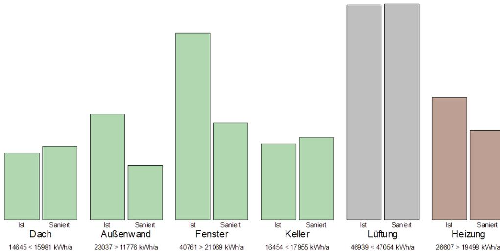
Der derzeitige Endenergiebedarf von 122.380 kWh/Jahr reduziert sich auf 97.387 kWh/Jahr. Es ergibt sich somit eine Einsparung von 16.847 kWh/Jahr, bei gleichem Nutzverhalten und gleichen Klimabedingungen.
