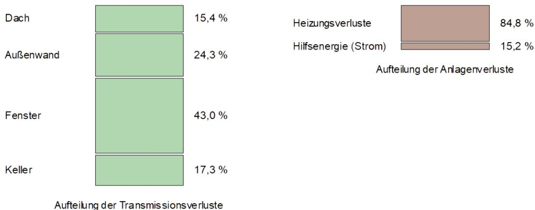
Abbildung 8 Aufteilung der Transmissions- Lüftungs- und Anlagenverluste
